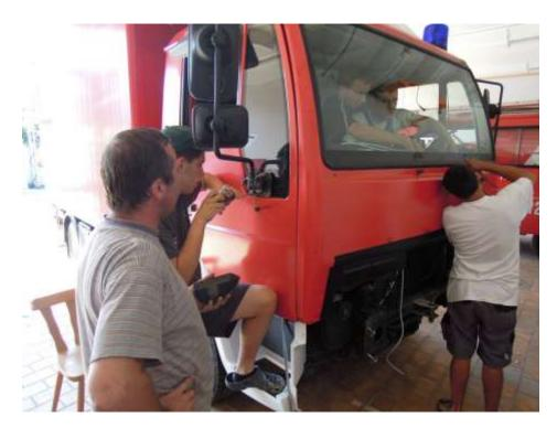
Dazu zählen: Blaulicht und Folgetonhorn, Blaulicht-Blitzer auf der Vorder- und der Hinterseite des Fahrzeuges, Zusatzblinker am Heck und die Versorgung des Fahrzeuges wenn dieses im Feuerwehrhaus steht. Damit das Fahrzeug immer mit Strom und Druckluft versorgt wird, mussten die Kabel, Schläuche und Kupplungen erst verlegt, installiert und angeschlossen werden. Auch die Verkabelung für ein Funkgerät und Handscheinwerfer musste erst vorgenommen werden.
