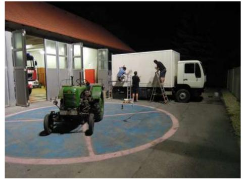
Im Anschluss daran begannen bereits die Vorbereitungsarbeiten für die Neulackierung des Fahrzeuges. Dazu mussten alle zu lackierenden Flächen angeschliffen und einige Stellen auch ausgebessert werden. Aufgrund der großen Fläche – speziell des Kastenaufbaus – dauerten diese Tätigkeiten ca. zwei Wochen und wurden teilweise auch bis in die Nachtstunden von unseren Kameraden durchgeführt.
